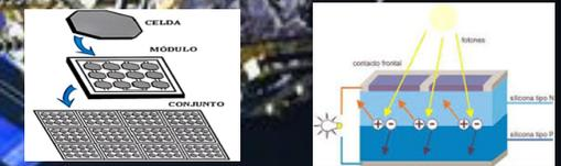
La cantidad de electricidad generada por una planta solar depende de cuantos módulos de celdas se conecten para generar esa energía, esto quiere decir que cuantos más módulos se conecten más electricidad se genera. Estos módulos se pueden conectar en paralelo o en serie según sea la necesidad de tensión o de corriente. [3]
